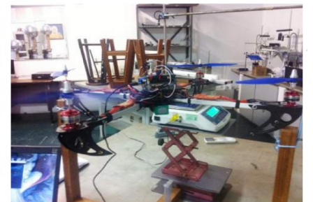
Figura 3 – Experimento da velocidade angular a direita e de Força a esquerda.
