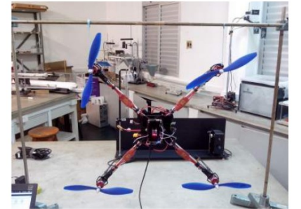
Figura 2 – Experimento do pêndulo bifilar com o quadrotor.
